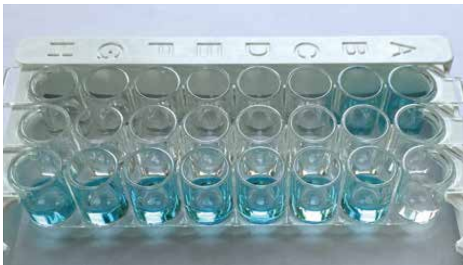
Ricerca di aflatossine nel latte mediante tecnica ELISA (enzyme linked immunosorbent assay).
